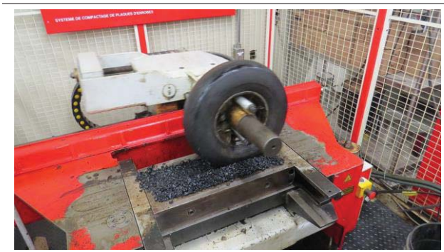
Figure 4.11 Le nouvel enrobé est compacté
