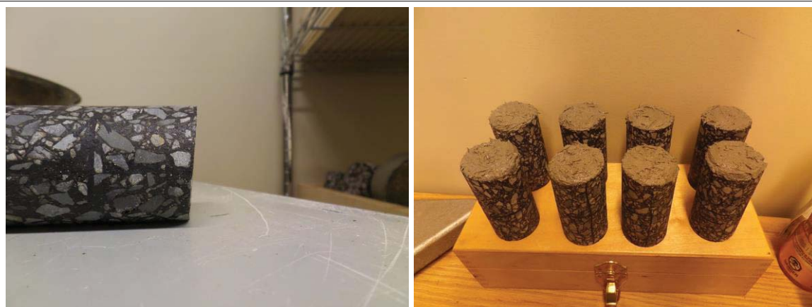
Figure 4.25 Mise en place du dispositif de CGD pour les éprouvettes avec joint vertical Une face de l'éprouvette est sciée en biais. Ensuite, on vient poser de la colle époxy sur cette face pour corriger la parallélisme entre les deux surfaces aux extrémités.
