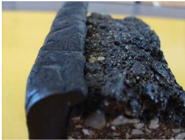
Figure 1.3 Profil de la bande bitumineuse Tok-Band SK Mark (Denso (2014))
