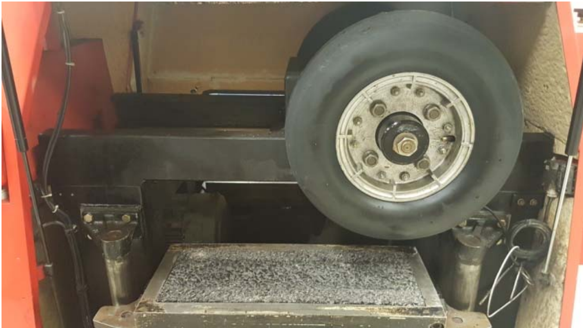
Figure 21 : Plaque d'enrobé de surface dans l'orniéreur
