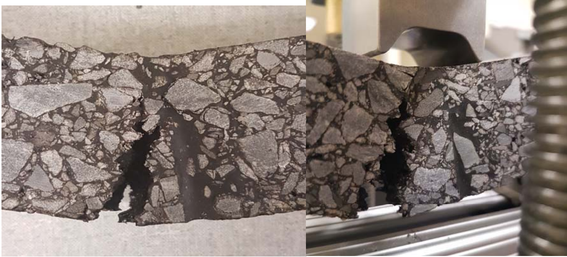
Figure 38 : Rupture des échantillons de bande bitumineuse #06 et #05 dans l'enrobé
