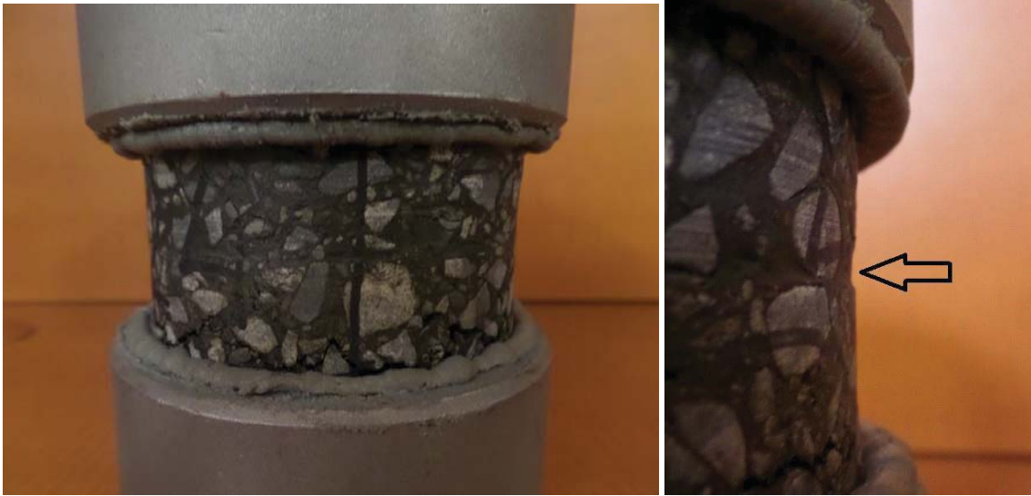
Figure 6.3 Éprouvette après l'essai d'arrachement
