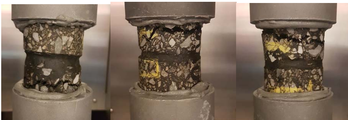
Figure 29 : Éprouvettes BB6, BB5 et BB1 avec bande bitumineuse toutes rupturées dans l'enrobé
