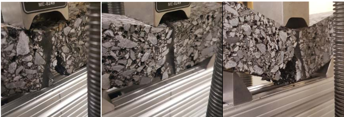
Figure 40 : Flexion importante des éprouvettes avec bande bitumineuse #o1, #o2 et #o3, déchirement dans l'enrobé
