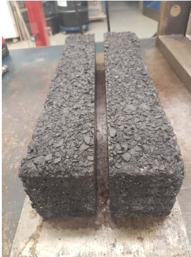
Figure 10 : Plaque d'enrobé sciée longitudinalement
