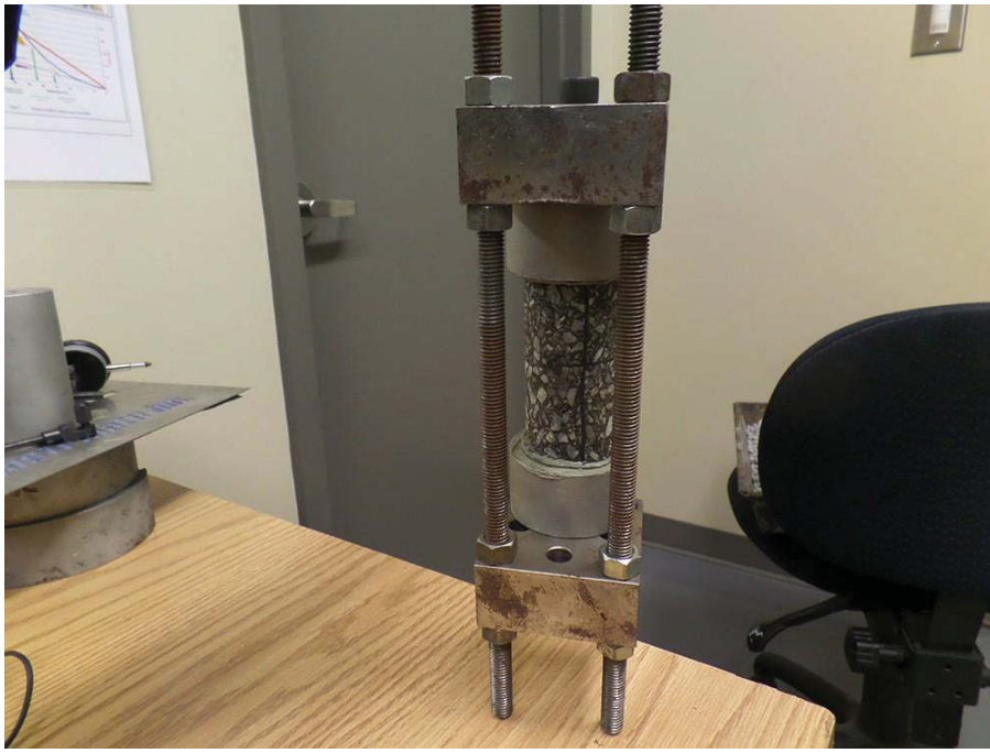
Figure 4.24 Les barres métalliques empêchent le retrait de l'éprouvette
