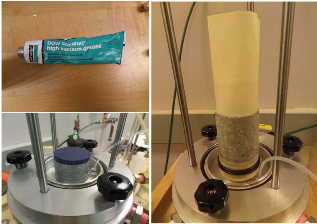
Figure 4.22 Premières précautions de mises en place du scellement à la base La graisse est appliquée sur la base pour assurer le scellement de la membrane. Une pierre poreuse est placée sur la base pour faire la liaison avec l'éprouvette.
