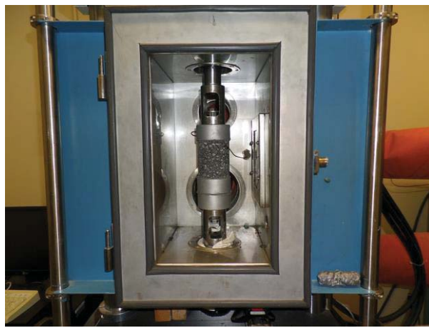
Figure 4.18 Presse hydraulique utilisée pour coller les autres casques
