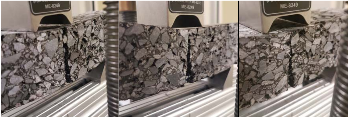
Figure 41 : Flexion de 3 mm causant la rupture complète dans le joint des éprouvettes #o1, #o2 et #o3 avec liant d'accrochage
