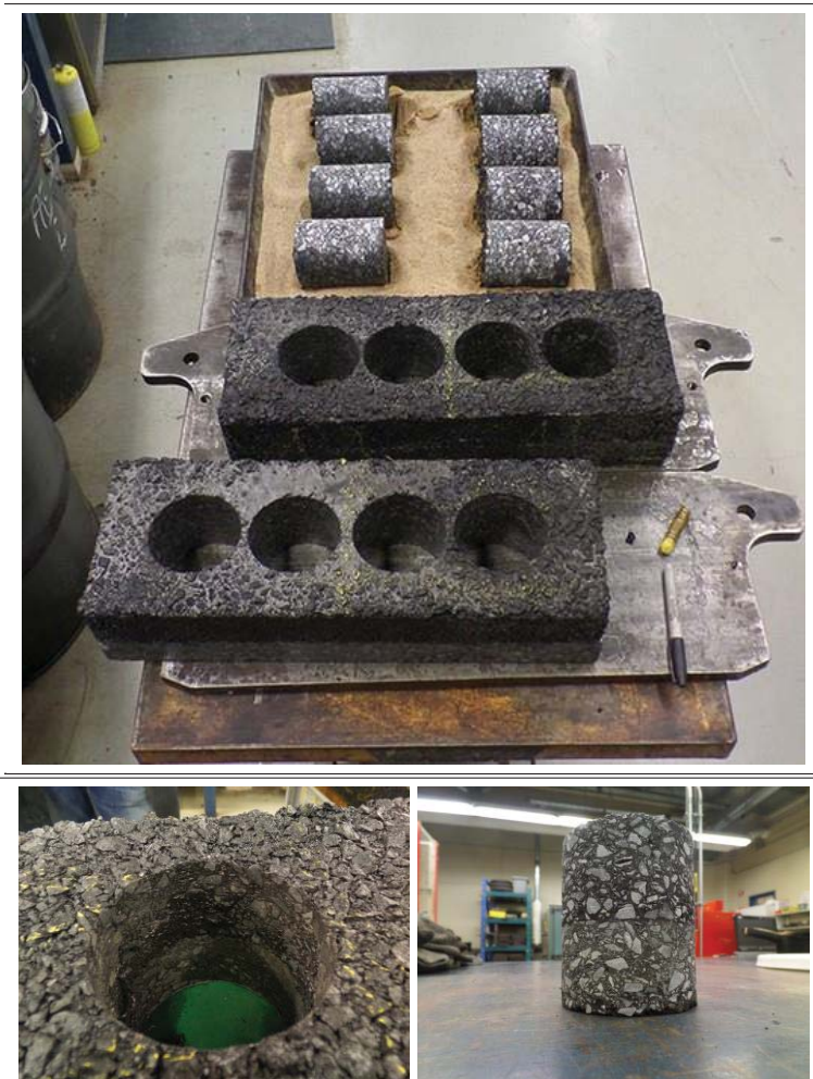
Figure 4.13 Plaques carottées pour les essais d'arrachement
