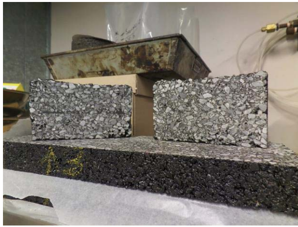
Figure 4.8 Deux coupes transversales de plaques sandwich (de gauche à droite : bande et liant) posées sur une demie plaque
