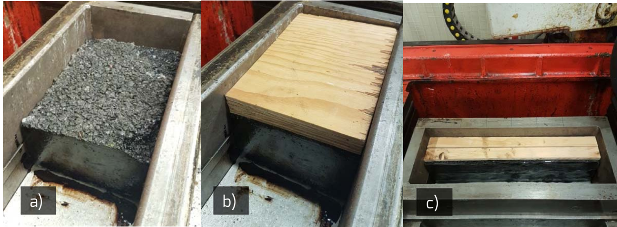
Figure 12 : a) Plaque avec joint transversal en position basse dans le compacteur, b) Planches de bois pour confiner l'enrobé à compacter du bon côté du joint (transversal) et c) Planches de bois pour confiner l'enrobé à compacter du bon côté du joint (longitudinal)
