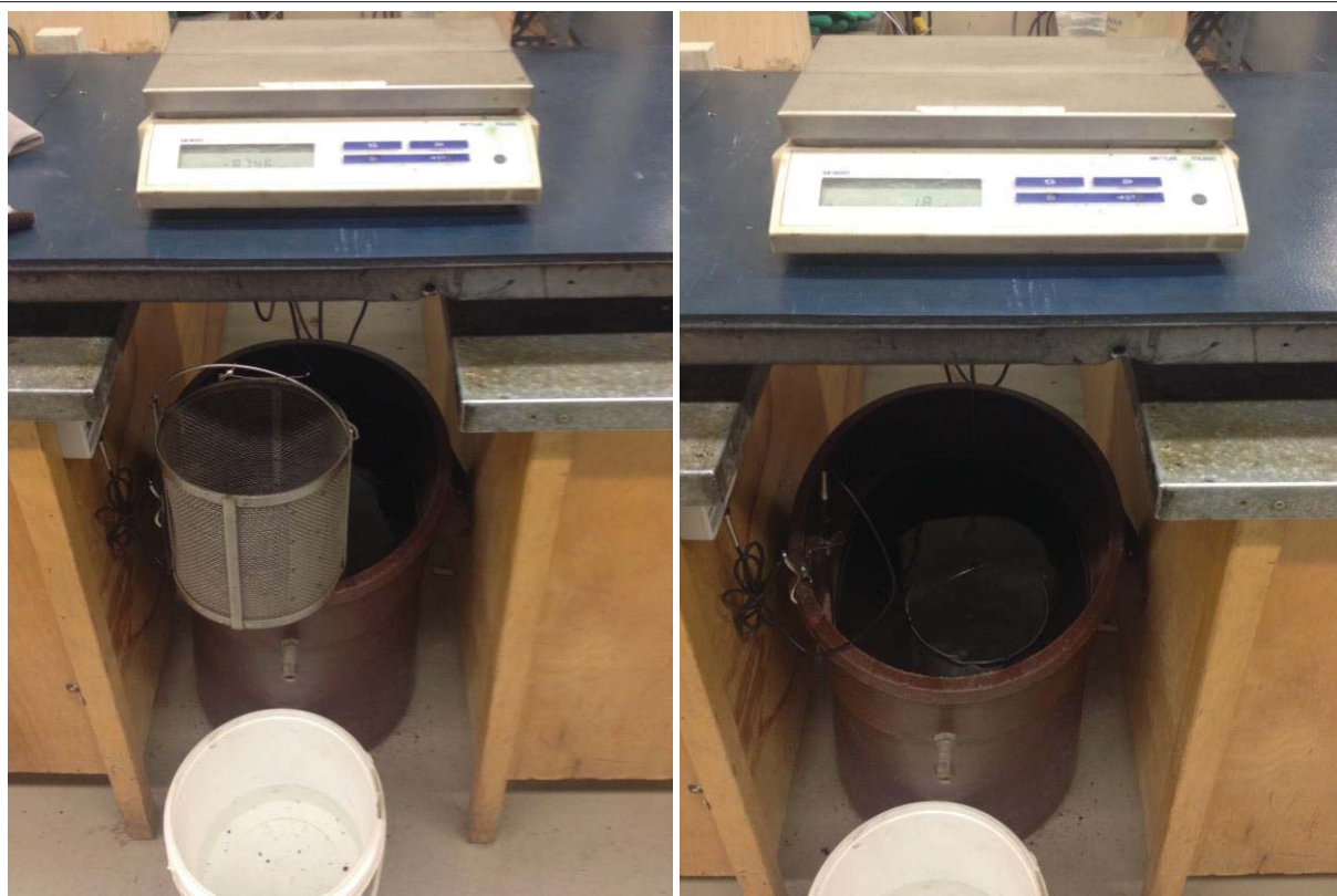
Figure 4.7 Photo du dispositif de pesée de l'échantillon lorsqu'il est immergé Le panier est relié par un câble à la balance. On plonge le panier dans le bac rempli d'eau à 25°C. On tare et ensuite on vient poser l'échantillon dans le panier.
