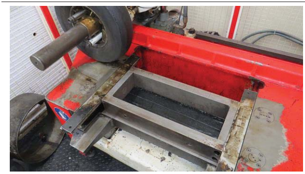
Figure 4.10 La demi-plaque est prête à recevoir la nouvelle couche d'enrobé
