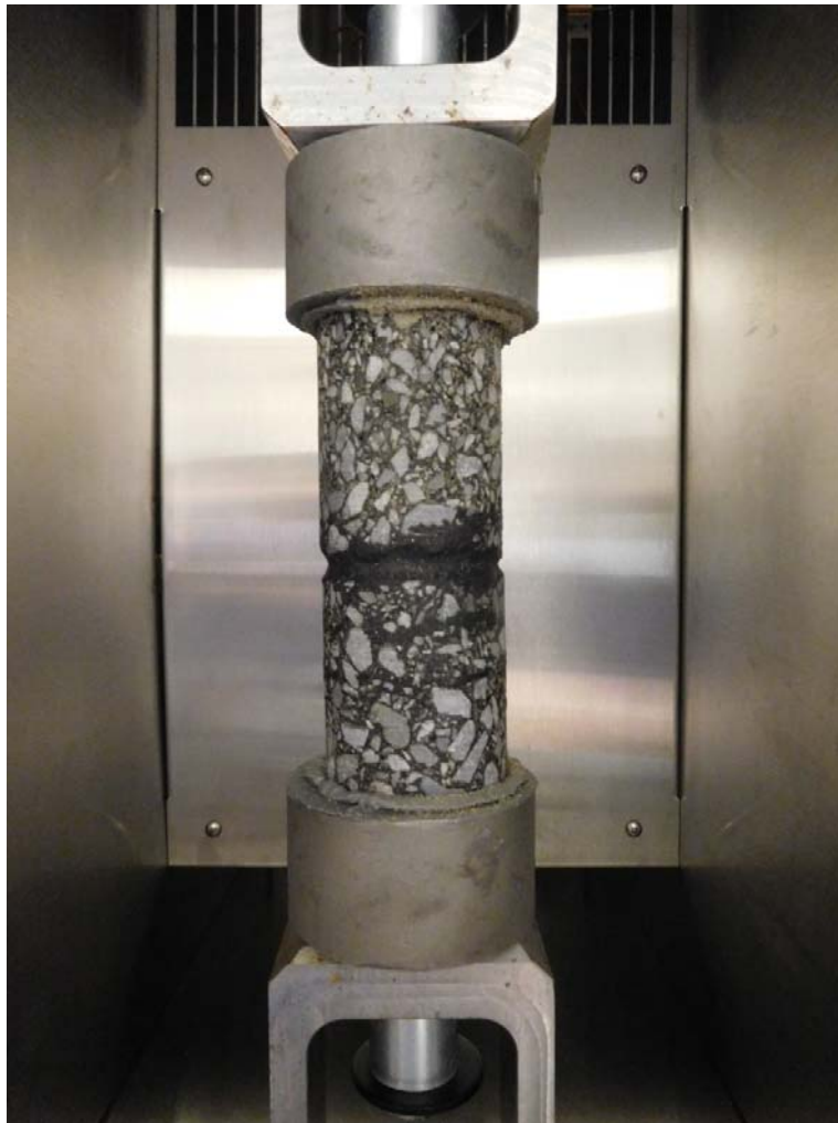
Figure 20 : Échantillon de bande bitumineuse dans la presse MTS
