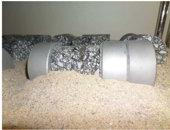
Figure 4.19 L'éprouvette est prête à être testée et entreposée dans un bain de sable pour prévenir les déformations dues au fluage
