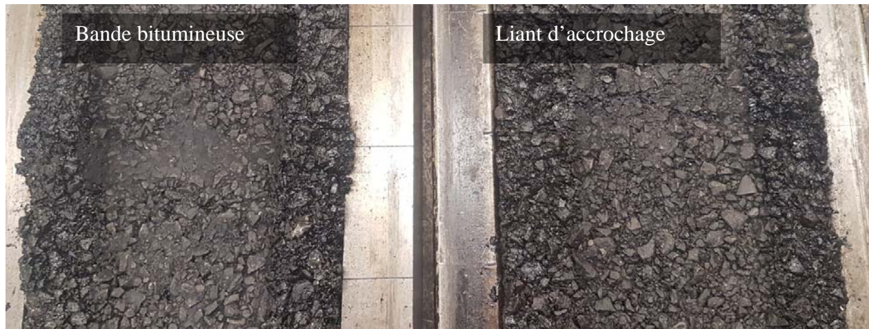
Figure 30 : Comparaison de l'affaissement pour chacun des systèmes de liaisonnement orniérés (30 000 cycles)
