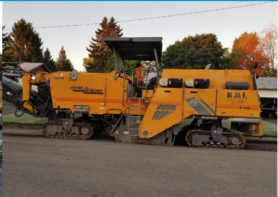
Planeuse utilisée : Wirtgen 2100
