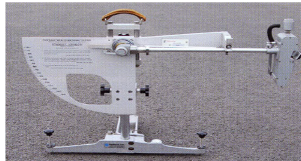
Figure 13 : Pendule SRT (source Cerema Département Laboratoire d'Ang
