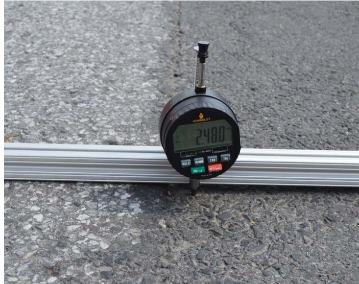
Figure 2 : Indicateur électronique à affichage numérique de 0-25mm, précision 0,001 mm
