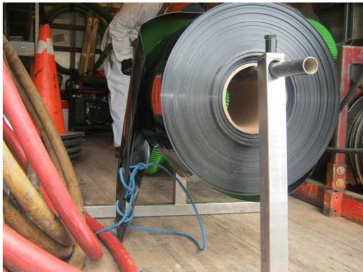
Figure 15 – Tambour avec le polythène d'insertion
