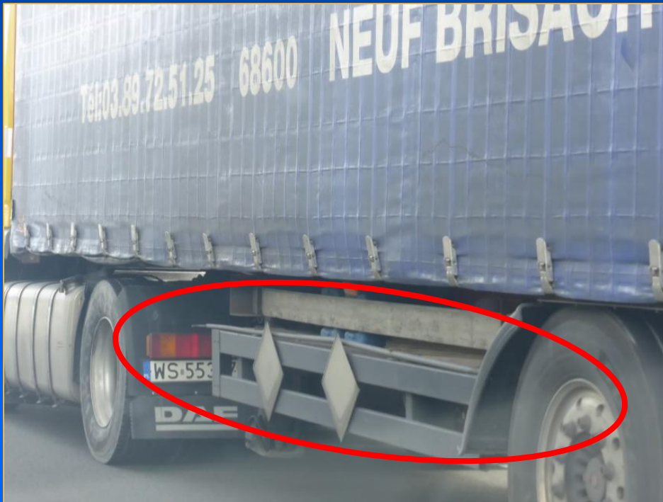
Protections latérales sur la remorque d'un véhicule lourd européen
