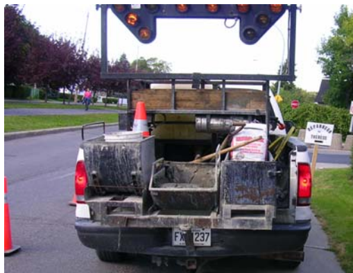
Figure A5-3 : Unité mobile pour la réparation des trottoirs de la Ville de Longueuil, arrondissement Vieux-Longueuil
