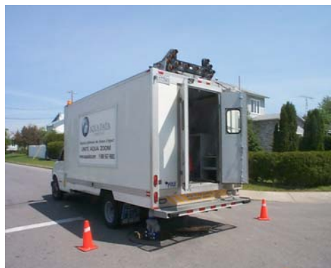
Figure 38 – Camion d'inspection par caméra à téléobjectif Gracieuseté de Aqua-Data
