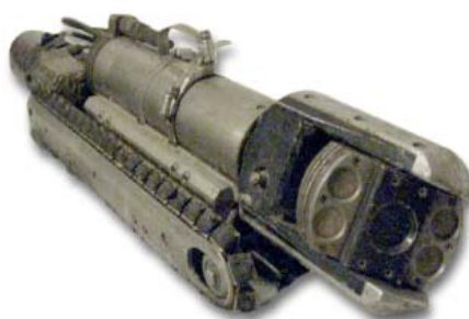
Figure 42 – Caméra d'inspection télévisée à tête rotative Gracieuseté M.S.C. Réhabilitation inc.
