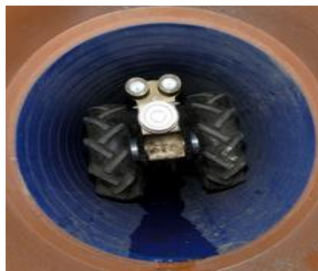
Figure 41 – Caméra d'inspection à l'intérieur d'une conduite Gracieuseté de Cues
