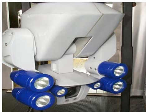
Figure 37 – Caméra à téléobjectif Gracieuseté de Aqua-Data
