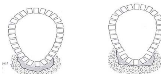
Figure 24 – Chute du radier 11
