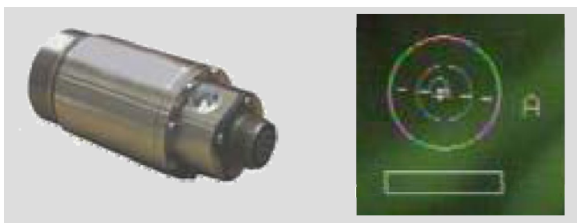
Figure 32 – Inclinomètre et image type lors d'un visionnement
