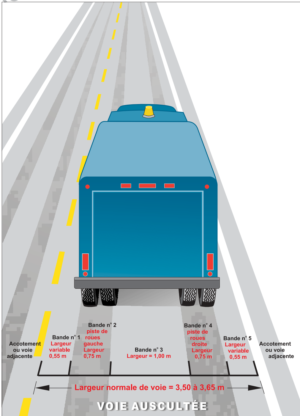
Figure 1-1 Détails des bandes d'auscultation pour la fissuration
