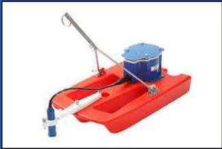
À l'aide d'un Doppler acoustique, procédez à l'établissement de 10 sections transversales dans la cellule du bassin de rétention
