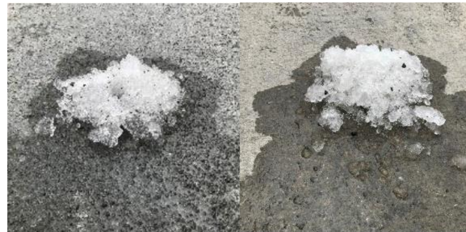
Figure 6.4-20 : Monticule de neige après 50 minutes d'activation (à gauche sur la membrane, à droite sur la dalle du trottoir)
