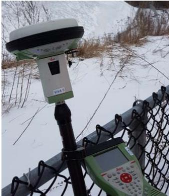
Station de référence GNSS pour la calibration du LiDAR (drone)
