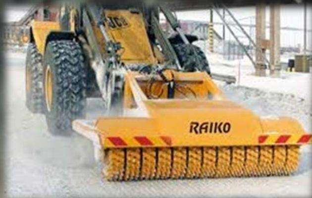
Avec une attache-rapide sur plusieurs types de véhicules (chargeur, rétrocaveuse, tracteur, véhicule à trottoirs) ou sur un camion de type «pick up» avec un rouleau remorqué
