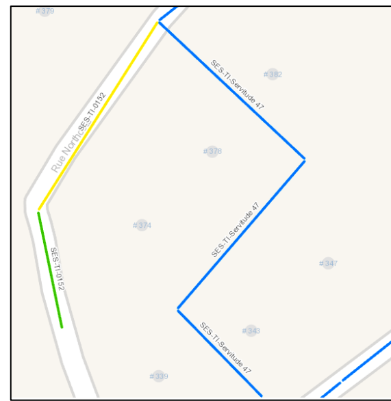
Figure 14. Application Territoires – Eaux usées – Indice d'état PIEMQ
