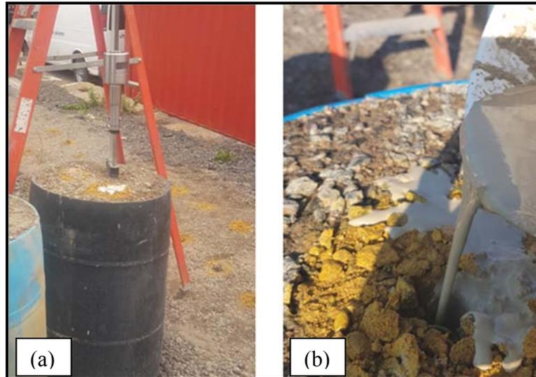
**Figure 7-5 (a) Troisième et dernier essai de pénétromètre sur le baril #1, (b) remplissage du trou laissé par le pénétromètre avec un coulis prise rapide en vue de l'essai suivant**
