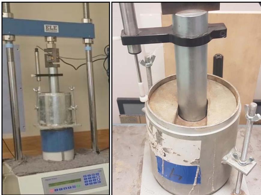
Figure 4-1 Montage de l'essai CBR
