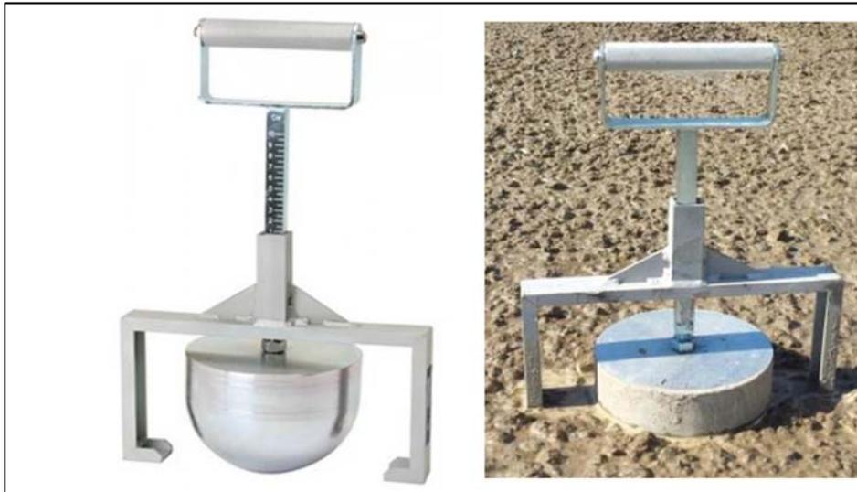
Figure 4-4 Boule Kelly déposée sur un RSR frais
