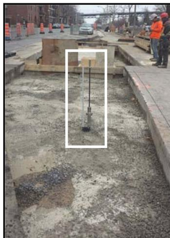
**Figure A5: Essai au pénétromètre dynamique 180 minutes après la coulée.
