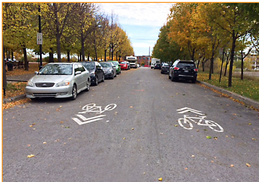
Figure 2.2: Chaussée désignée (photo)
