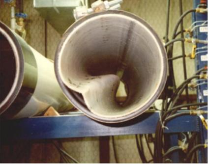
**Flambement** : annulation de la raideur en flexion et augmentation rapide de la flèche qui entraîne la rupture du liner.
