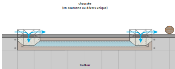
Fosse végétalisée drainante
