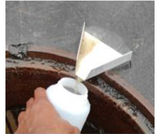
Échantillonnage manuel : eau de ruissellement zone imperméable
