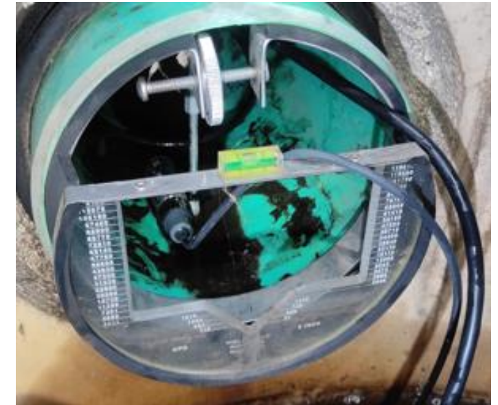
Mesure des débits des zones perméable et imperméable (déversoirs Thelmar et sondes de niveau HOB0 MX2001)
