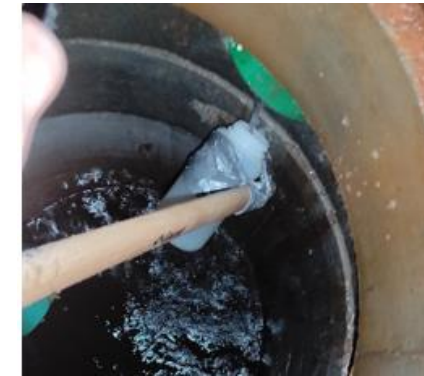
Échantillonnage manuel : drain de la zone perméable
