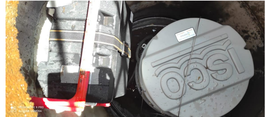
Échantillonnage automatique : eau zone imperméable vers réseau (ISCO 3700)
