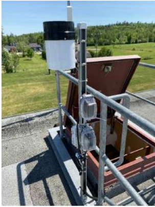
Pluviomètre à auget chauffant ONSET S-RGB-M002
