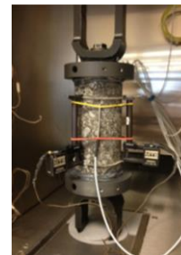
Essai de fatigue TC sous sollicitation sinusoïdale cyclique
