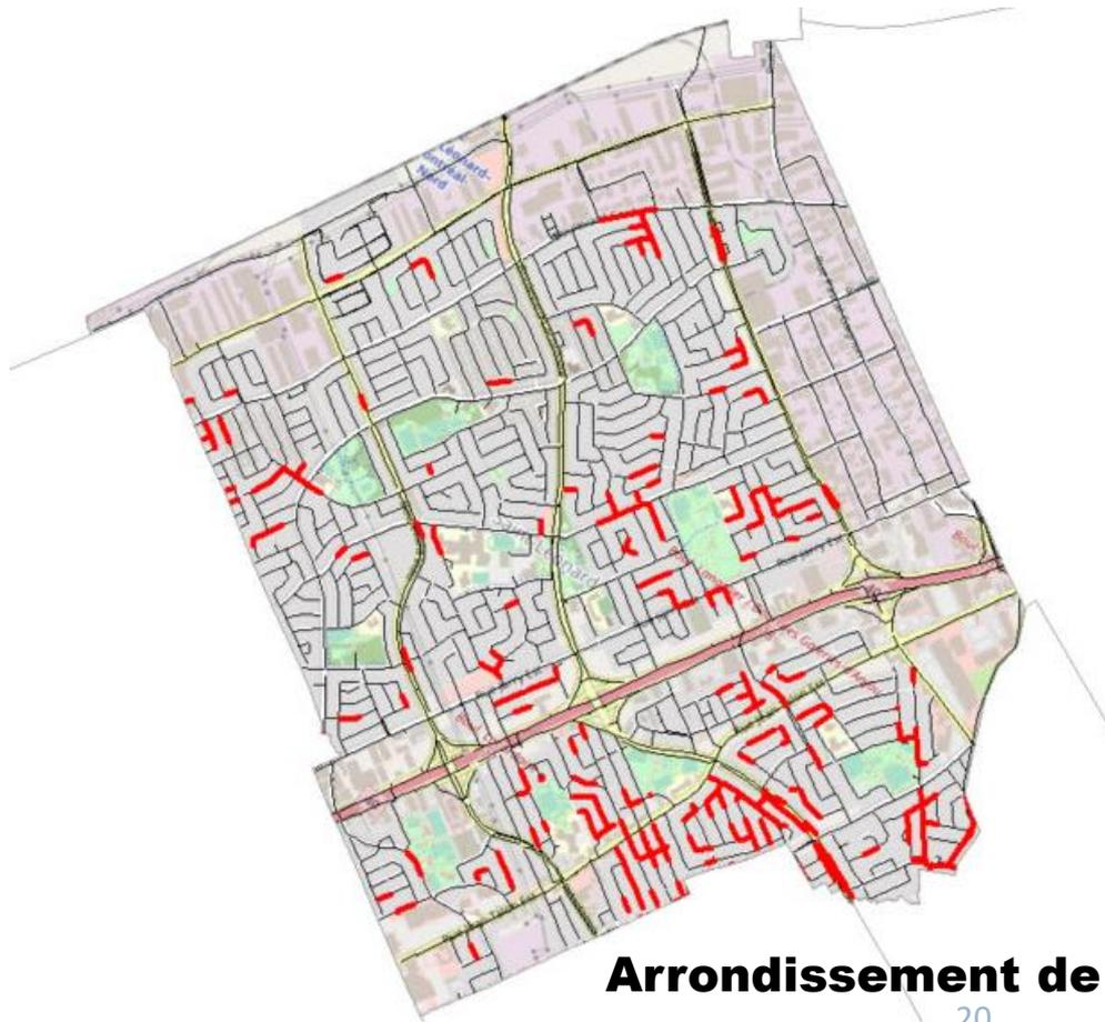
Conduites traversant **cuvette**, à proximité de **constructions avec garage sous-sol en contre pente**, qui a fait l'objet de **plaintes** de refoulement ou d'inondation,
