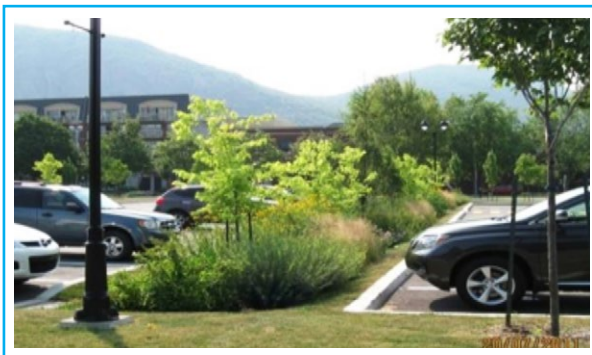
Figure 10.6 : Jardin de pluie dans un stationnement (Mont-Saint-Hilaire, QC, Canada)
