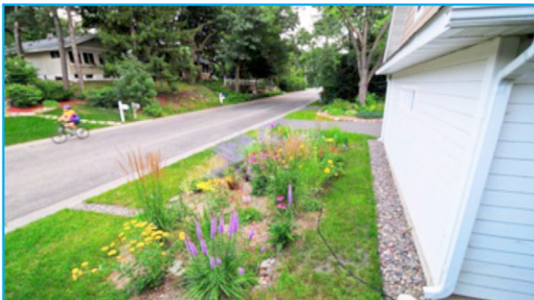
Figure 7.7 : Déconnexion des eaux pluviales (Union Saint-Laurent Grands Lacs, 2010)
