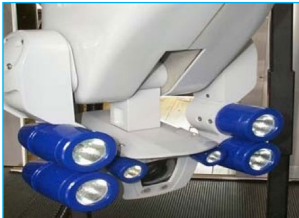
Figure 36: Caméra à téléobjectif (crédit-photo: Aqua-Data)
