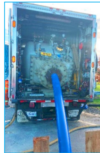
Figure 7.2: L'équipement de l'insertion par projection (Consultants GAME)
