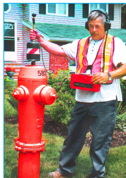
Figure 3.1: Détection de fuites acoustique
