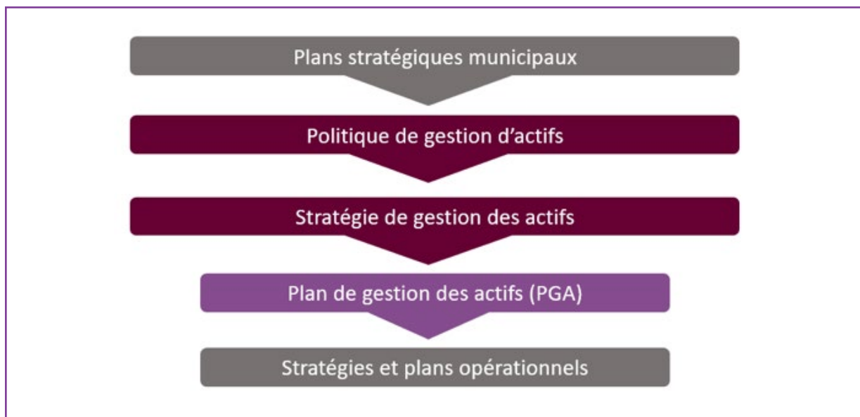
Figure 1.1: Hiérarchie des documents de la gestion des actifs Adapté de « Hiérarchie d'un système de gestion des actifs », Fédération Canadienne des Municipalités, 2018
