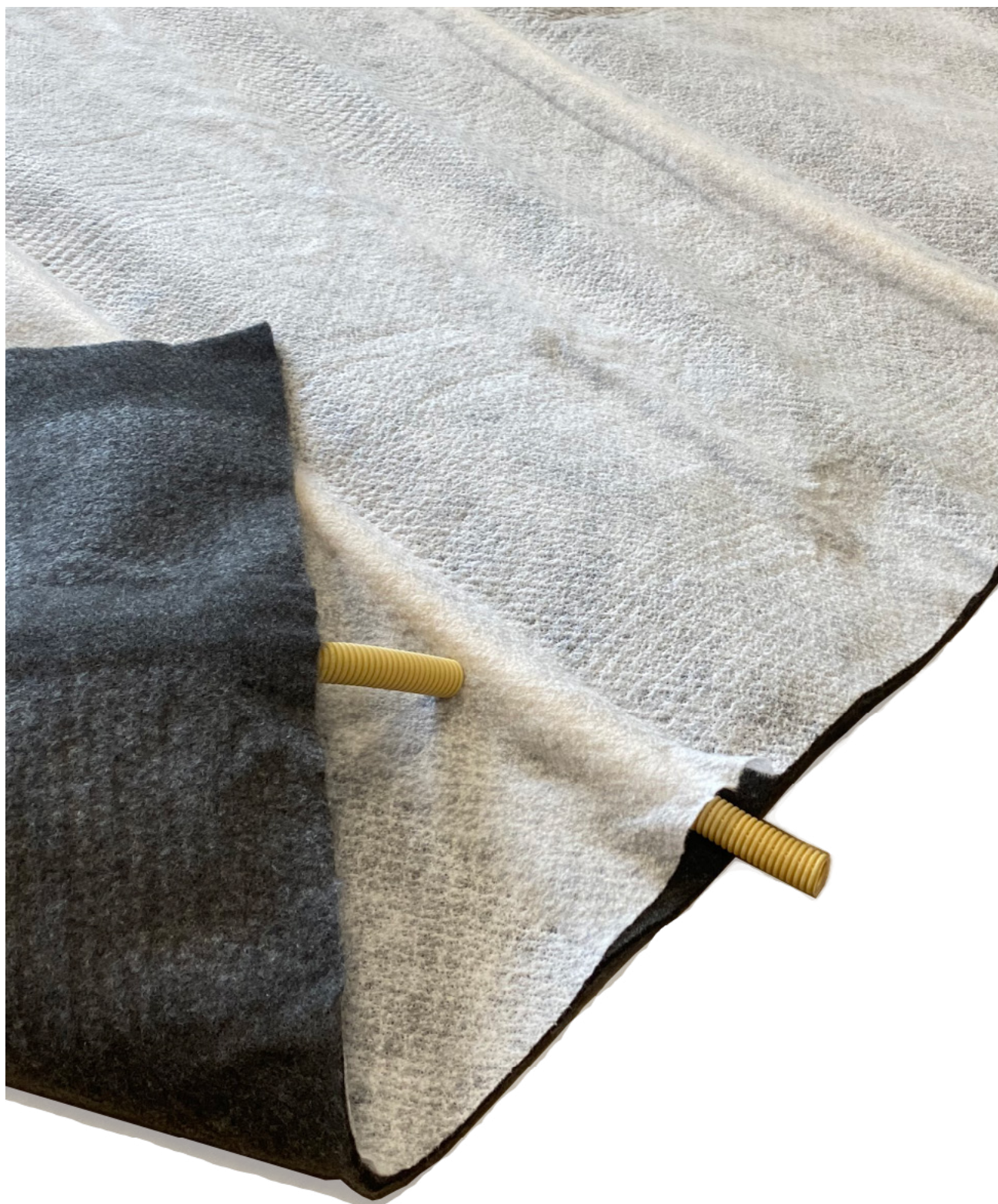
Figure 13 : Exemple de géocomposite avec mini-drain qui peut être utilisé comme CDI.
