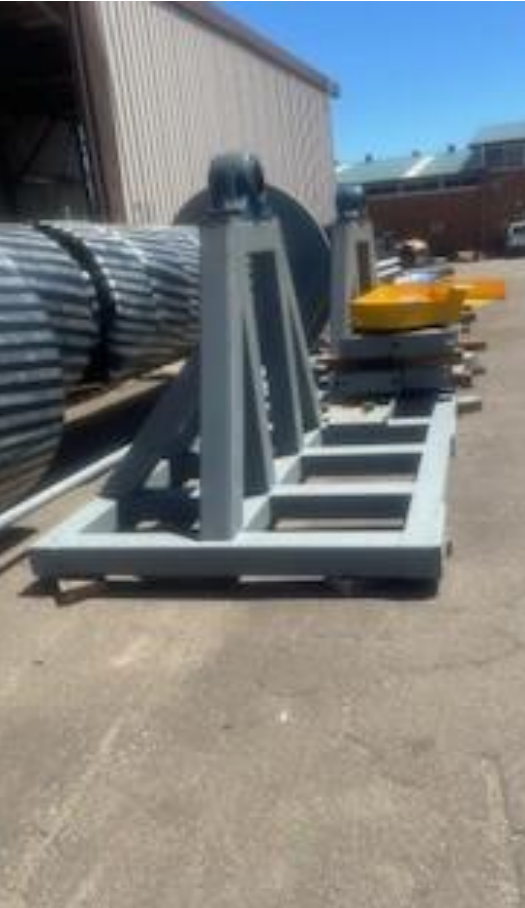
La machine de déroulement peut être démontée pour s'adapter à un camion à plateau ou un conteneur 200T
