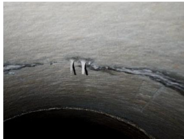
Autocicatrisation d'une fissure longitudinale
