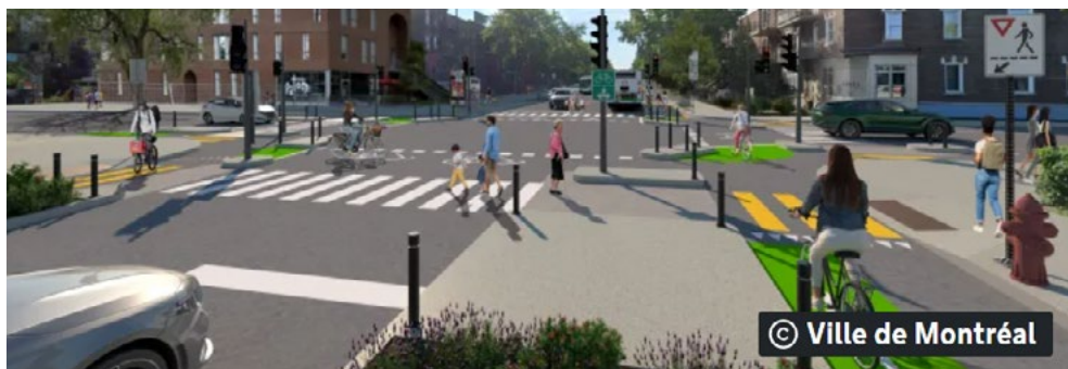
Figure 13 – Intersection protégée pour cyclistes à la hollandaise, rues Bellechasse et Christophe-Colomb, Montréal. Source : adaptée du site Web de la Ville de Montréal
