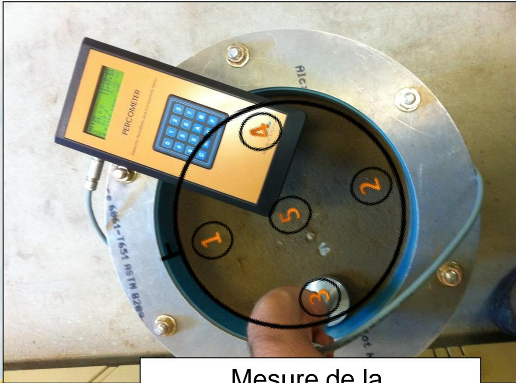
Mesure de la constante diélectrique (DV) Avec percomètre
