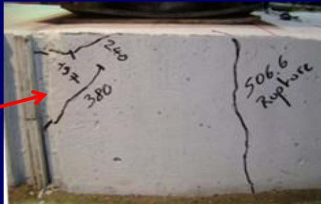
Rupture par cisaillement du béton
