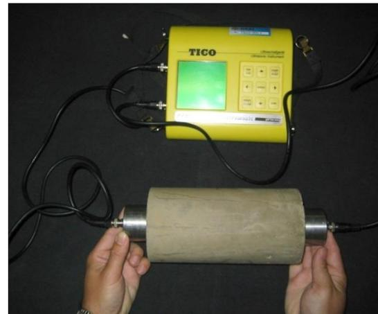
Consistent à envoyer des ondes ultrasonores  $P$  et à enregistrer le signal d'arrivée.
