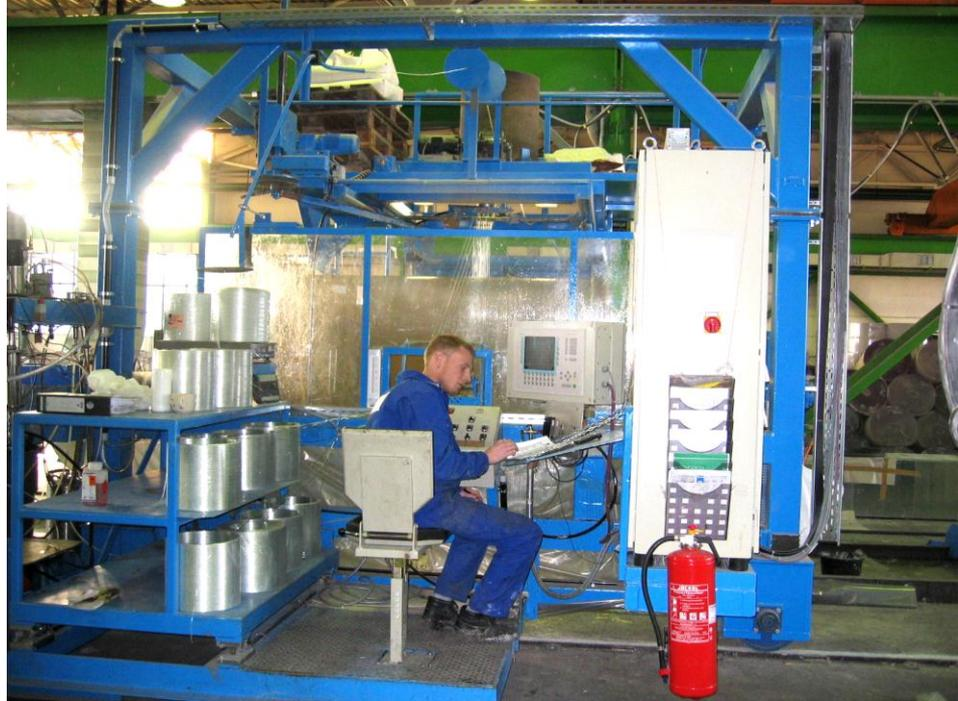
La fabrication par système automatisé d'enroulement filamentaire
