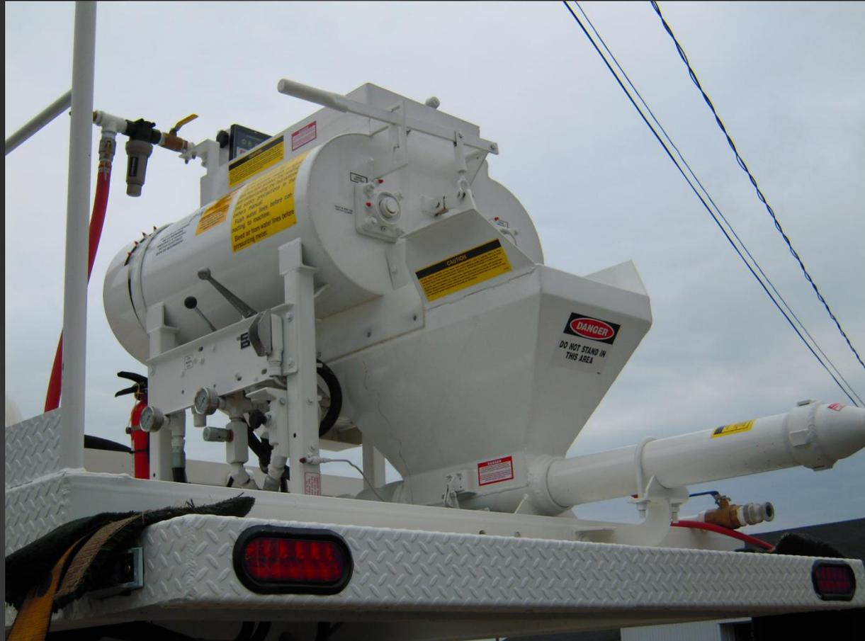
Mélangeur et pompe à béton
