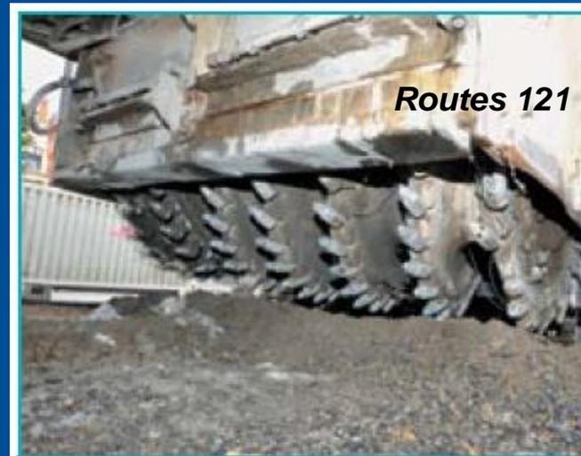
Le rotor de l'atelier mobile de retraitement permet d'assurer une bonne homogénéité du matériau et une profondeur homogène du malaxage.
