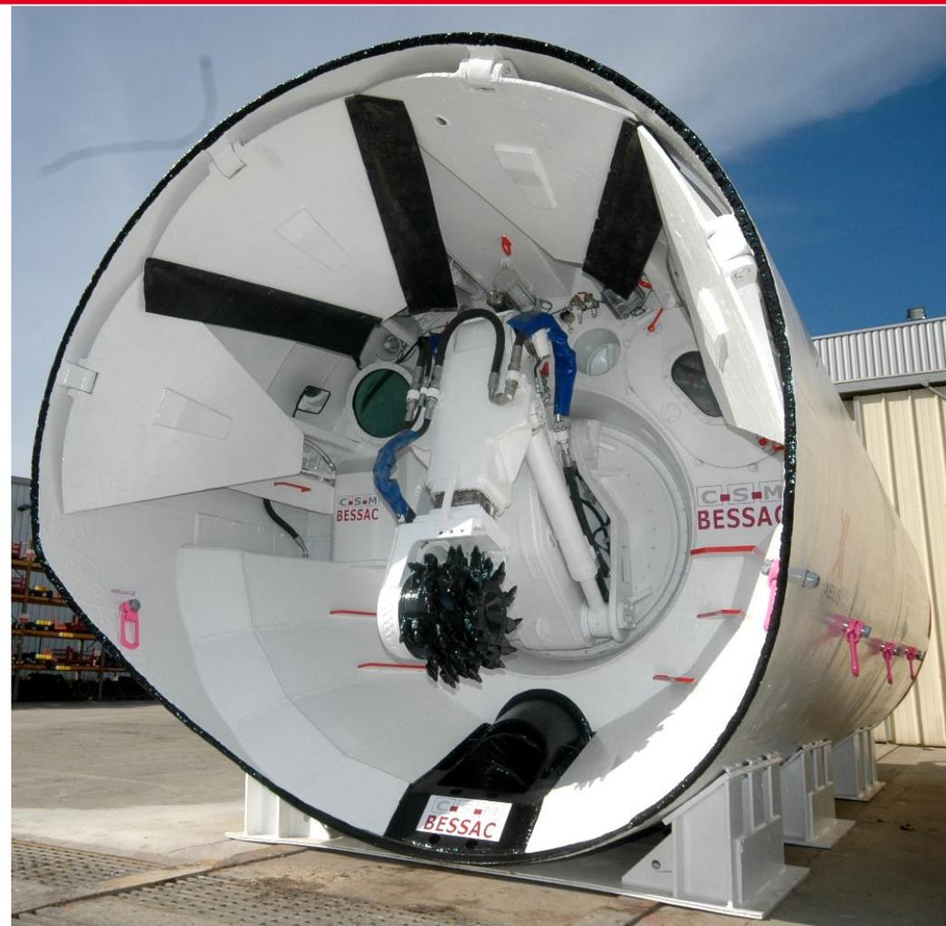
**Creusement au tunnelier à attaque ponctuelle**
