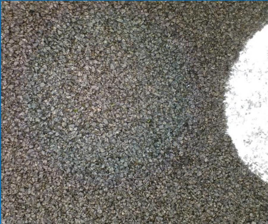
**Lissage** (PMT # 0,5 mm)
