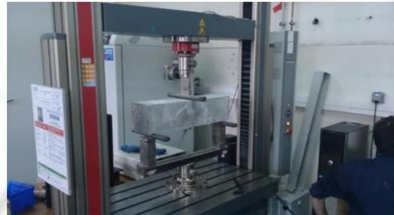
essais de traction par flexion – NF EN 14651
