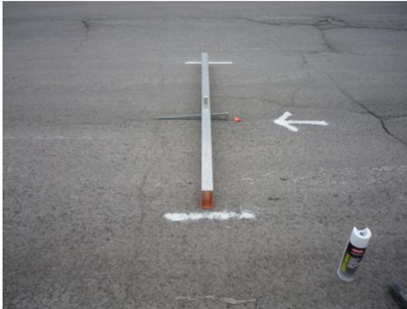
Photo n° 1 : Relevé en condition de chaussée gelée le 7 mars 2013 (mesure = 34,0 mm)
