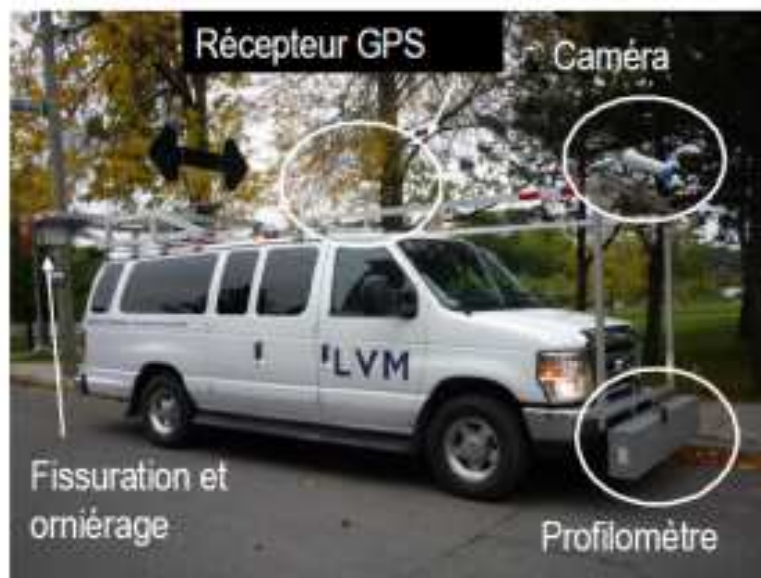
Figure 1: Véhicule multifonction de relevés routiers de LVM
