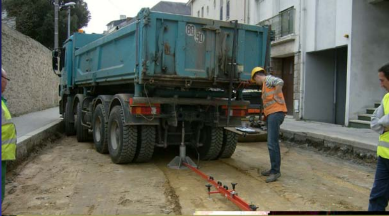
Portance minimale à respecter pour compacter: contrôles de déflexion, portance
