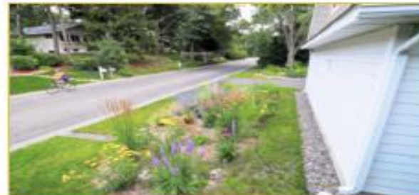
Figure 5.8: Déconnexion des eaux pluviales (Union Saint-Laurent Grands Lacs, 2010)
