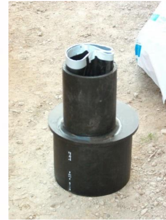
Pièce de raccord avec manchon thermorétractable
