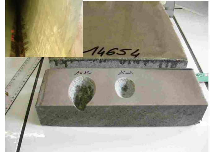
Essai d'abrasion – test CNR
