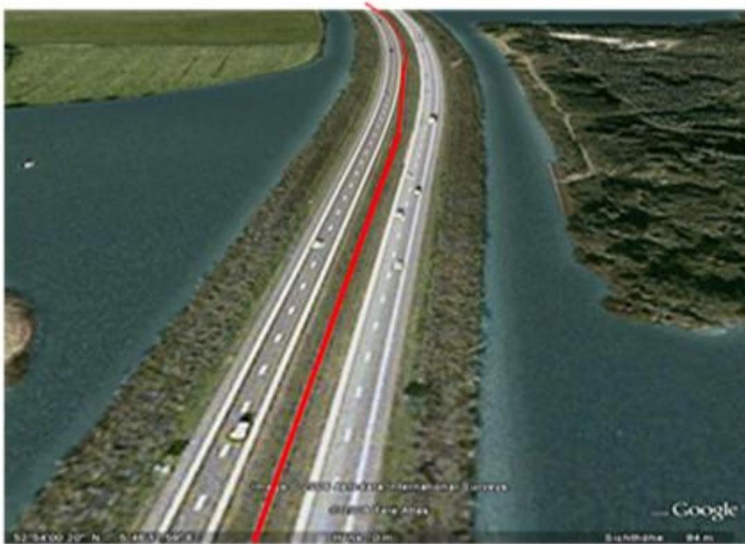
Fig. 6: Illusion de distance involontaire à le point d'un accident aux Pays-Bas : barrières de sécurité est dévié tout à coup vers la gauche (4)
